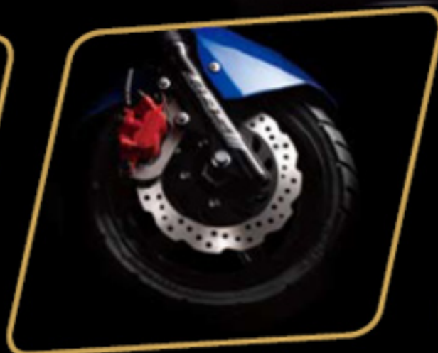
高制動浪花碟前煞 245mm浪花碟搭配雙活塞卡鉗， 完美制動力及高散熱性，創造經典操控！
