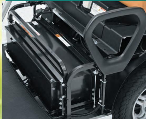
採用具有優異熱穩定性的磷酸鐵鋰離子電池，獲得高可靠度和長壽命。提供4kWh電池搭載車，和6kWh電池搭載車，您可以根據續航距離和路線特性進行選擇。
