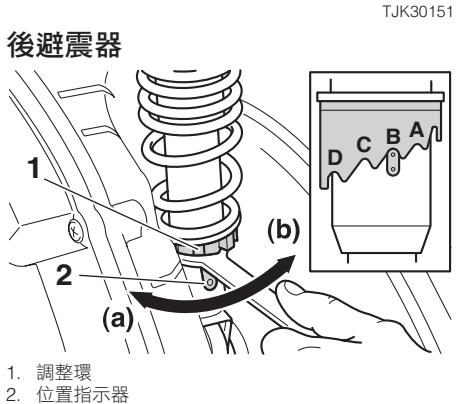
(a)方向旋轉。如要讓後避震器變得較硬，可將調整環往(b)方向旋轉。調整後，必須確定後避震器的位置指示器，已固定在調整環的凹槽內。
