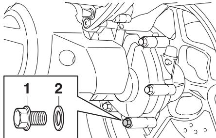
6. 安裝齒輪油排油螺栓和新的墊圈，將螺栓鎖緊至規定的扭力。
