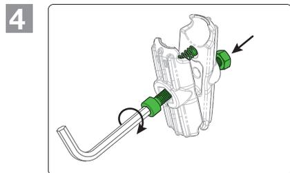
搭配螺絲及螺帽鎖上支架，可先不完全鎖緊，待組回球頭及手機座後，調整好視角，再將其確實鎖緊。
