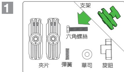
取下支架，將旋鈕整個鬆開，拆開後的零組件如圖。
