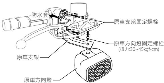
2. 以原車支架固定螺栓與原方向燈固定螺栓，將④固定支架與方向燈固定。
