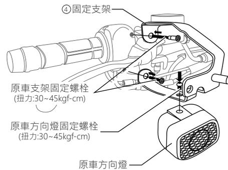
3. 將①彈簧夾片固定於手⑤把保護蓋鎖孔上，並將③有帽螺栓穿過②軸環鎖固於④固定支架上，並鎖回原車方向燈固定螺栓。
