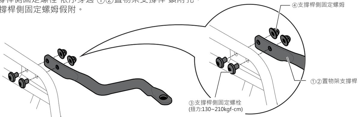
4. 將 ⑤支撐桿下固定螺栓 穿過 ①②置物架支撐桿 及 ⑥置物架上固定座鎖附孔。
