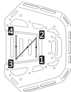
3. 將 ③支撐桿側固定螺栓 依序穿過 ①②置物架支撐桿 鎖附孔，並以 ④支撐桿側固定螺帽 假附。
