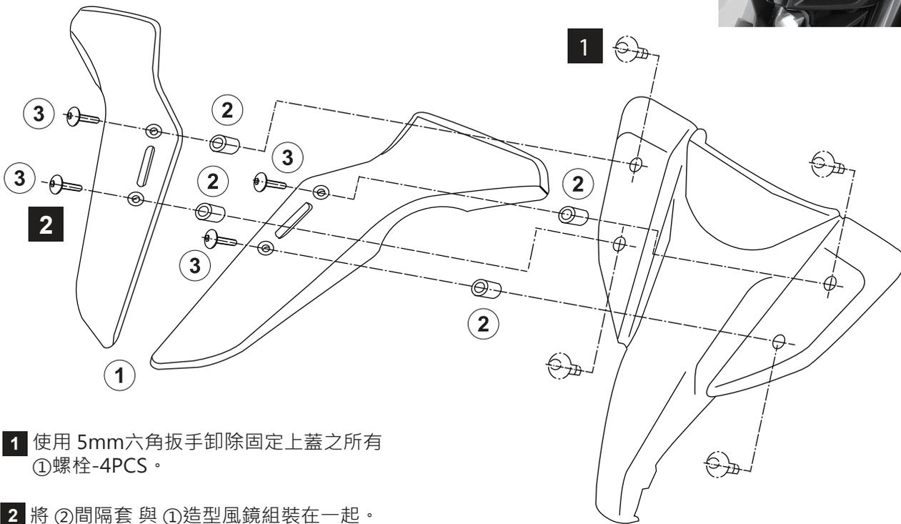
**1** 使用 5mm六角扳手卸除固定上蓋之所有
