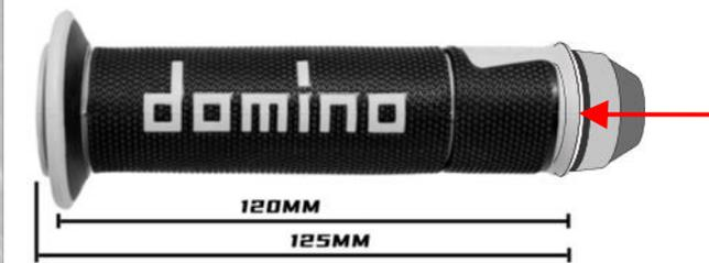
注意：安裝時請預留握把套與平衡端子間隙，避免操作油門時卡住。
